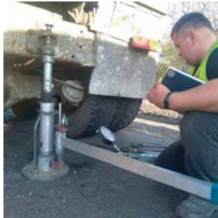
Рисунок 1.14 — Визначення модуля пружності асфальтобетонних шарів дорожнього одягу динамометричними установками ударної дії (зліва — універсальне дорожнє вимірювальне обладнання «УДВО», зправа — установка динамічного навантаження «ДИНА-3М»)
