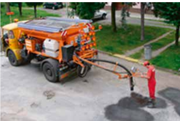
Рисунок 8.7 — Машина для ямкового ремонту
