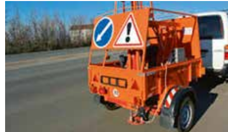
Рисунок 1.14 — Визначення модуля пружності асфальтобетонних шарів дорожнього одягу динамометричними установками ударної дії (зліва — універсальне дорожнє вимірювальне обладнання «УДВО», зправа — установка динамічного навантаження «ДИНА-3М»)
