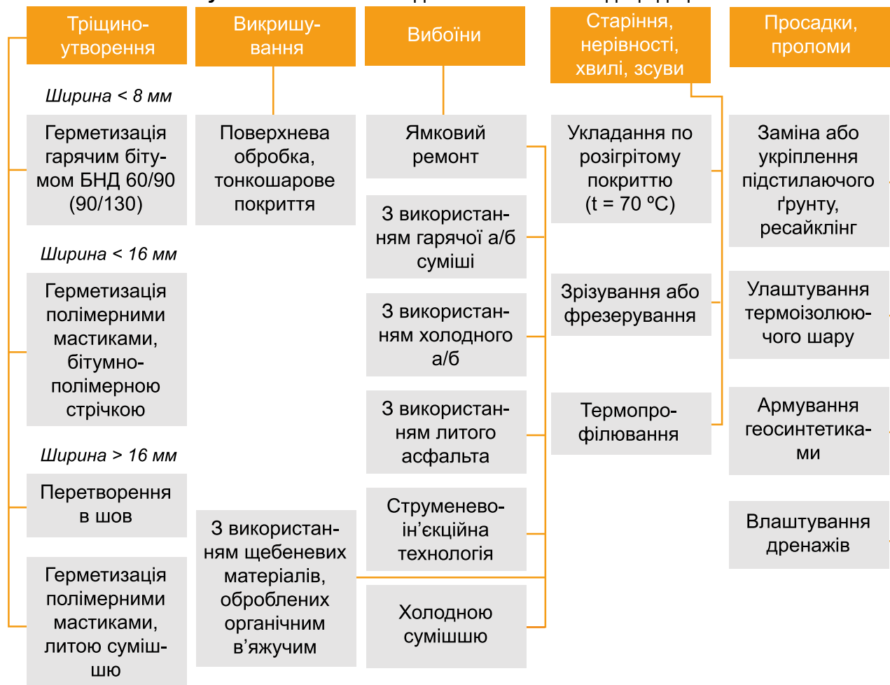
Рисунок 8.23 — Рекомендовані способи ліквідації дефектів
