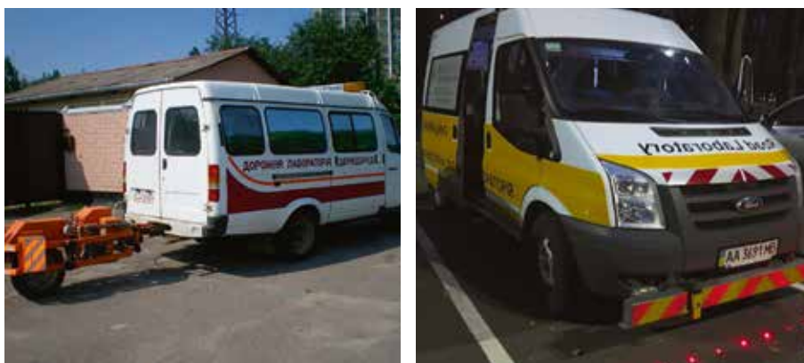
Рисунок 1.18 — Діагностика стану дорожніх покриттів ходовими дорожніми лабораторіями
