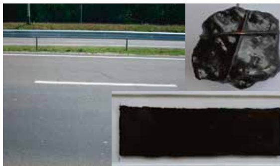
Рисунок 4.7 — Ефект із використанням адгезійної добавки
