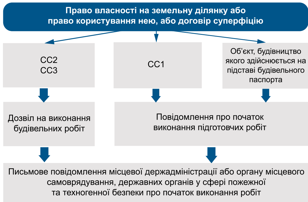
Рисунок 7.4 — Процедури до початку будівельних робіт
