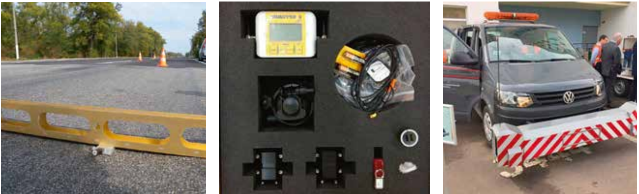
Рисунок 1.16 — Вимірювання нерівностей основи та покриття (зліва направо: рейка РДУ-КОНДОР, IRI METER, профілограф)
