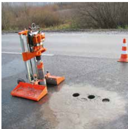
Рисунок 1.15 — Визначення товщин та складу шарів дорожньої конструкції шляхом відбирання зразків-кernів кернавідбірником
