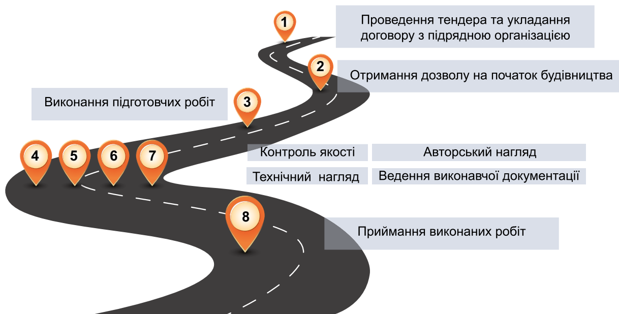
Рисунок 7.2 — Порядок здійснення будівельних робіт
