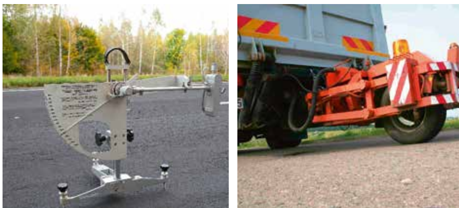
Рисунок 1.17 — Визначення коефіцієнтів шорсткості та зчеплення колеса з поверхнею асфальтобетонного покриття (зліва — портативним приладом, зправа — динамометричною установкою)
